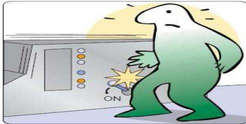
**Avviamento accidentale della macchina, specialmente nei torni di vecchia costruzione dove il comando di messa in moto del mandrino è del tipo a leva sporgente.**
