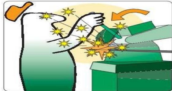
**Proiezione di materiali (trucioli)** con possibilità di gravi danni agli **occhi**.
